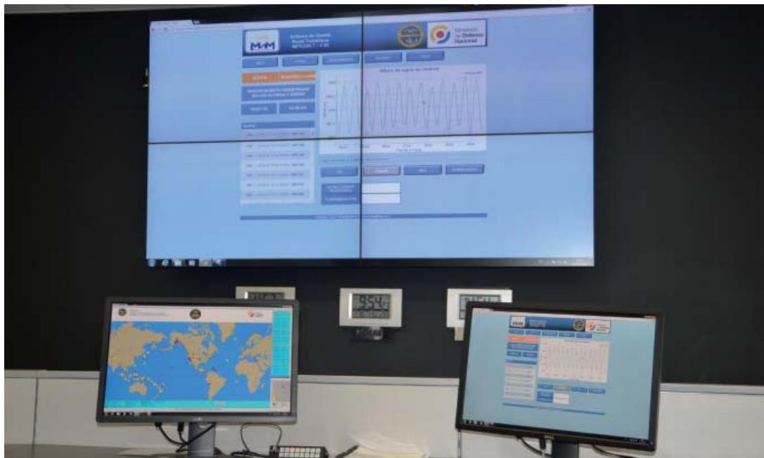
El GLOBAL NETCOM es un multicentro de control que permite de un modo sencillo obtener datos e interactuar sobre las estaciones remotas instaladas en faros, boyas y balizas (ayudas a la navegación), mostrando la información de un modo claro en una pantalla de ordenador.
